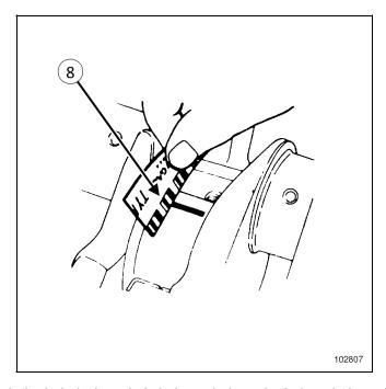
게이지를 사용하여(8)포장지에 인쇄된 다음회전방향 움직임 측정 테이프편평 유격을 측정한다.
