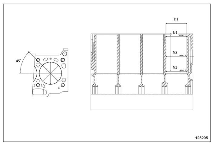
다음을 사용: 다이얼 게이지캠샤프트 저널의 (D1) 엔진 블록 실린더 간격  $45^\circ$  (4 개의 대각선)을 세 가지 수준 ((N1), (N2) 및 (N3))에서 10mm, 60mm 및 130mm 실린더 헤드 접촉면으로부터의 깊이 12 각 실린더에 대한 직경 값.
