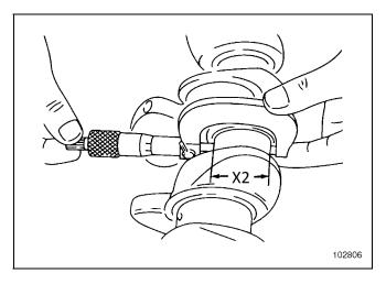
다음을 사용하여외부 마이크로미터각 실린더 헤드 베어링의 직경을 측정한다.(X2)크랭크샤프트 크랭크핀 직경(접촉면 중심) 측정 및 점검측정 값은 43.953~43.971 mm 사이여야 한다..
