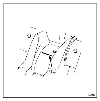
피스를 절단한다.회전방향 움직임 측정 테이프 <u>(11)</u>. 베어링 오일 홀을 피하여 와이어를 크랭크샤프트 저널 축에 위치시킨다. 윤활하지 않고 장착<u>(참조: 크랭크샤프트 : 탈거 - 장착 )</u>:
