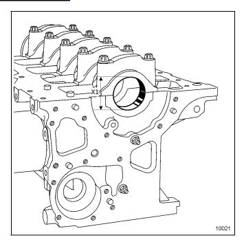
다음을 사용하여 측정한다: 내장 마이크로미터 직경 (X1) (크랭크 샤프트 베어링)은 최소 55.997mm와 최대 56.017mm 사이여야 한다.
